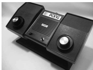
Figura 7.2: El hardware de Atari Pong estaba especialmente pensado para el manejo de las dos palas que forman el juego.
