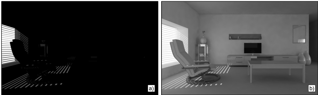
Figura 7.2: Ejemplo de resultado utilizando un modelo de iluminación local y un modelo de iluminación global con la misma configuración de fuentes de luz y propiedades de materiales. a) En el modelo de iluminación local, si no existen fuentes de luz en el interior de la habitación, los objetos aparecerán totalmente “a oscuras”, ya que no se calculan los rebotes de luz indirectos. b) Los modelos de iluminación global tienen en cuenta esas contribuciones relativas a los rebotes de luz indirectos.
