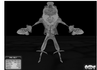
Figura 12.21: Figura con sus vértices desplazados en dirección de sus normales.
