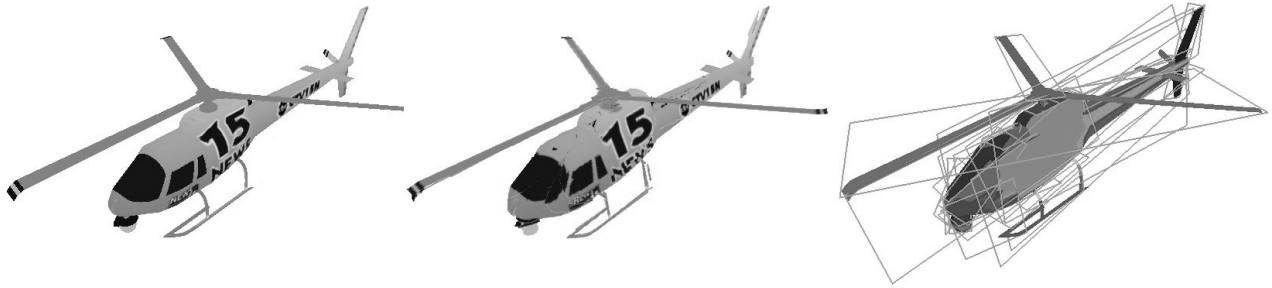
Figura 8.8: Modelado de un helicóptero mediante nube de billboards.
