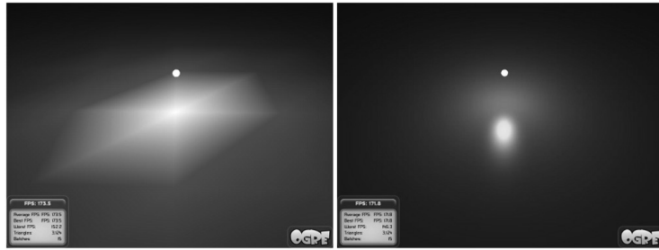
Figura 12.6: Diferencia entre Per-Vertex Lighting (izquierda) y Per-Pixel Lighting (derecha).
