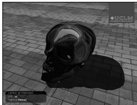
Figura 7.12: Un material más complejo que incluye la definición de una texture_unit con diversas componentes de sombreado.
