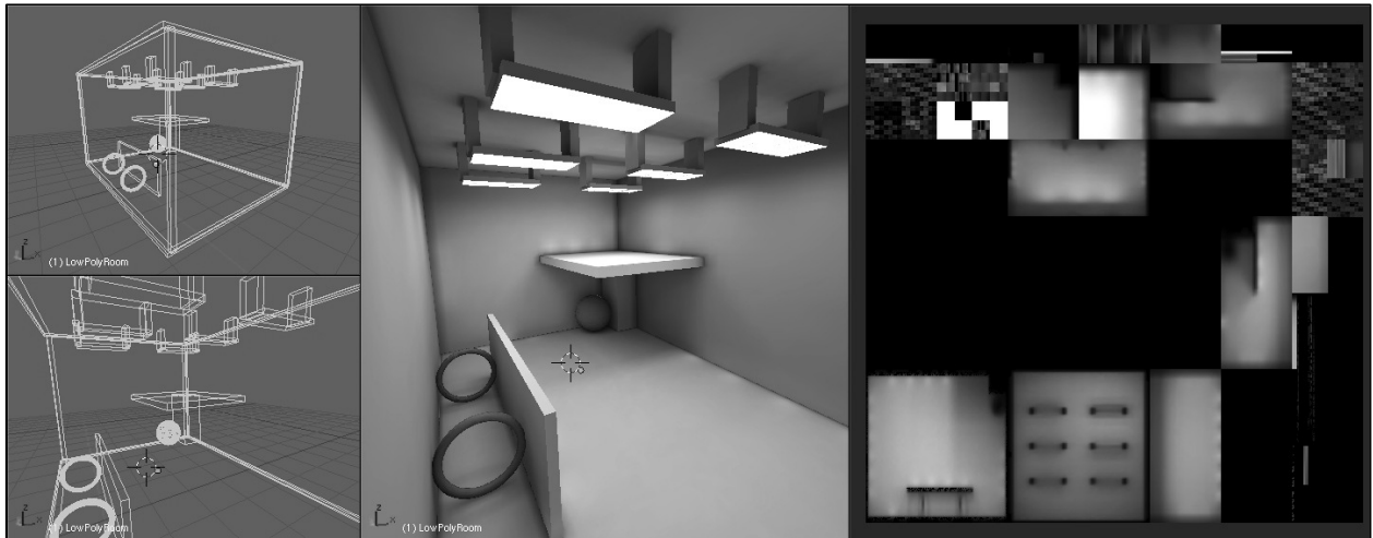
Figura 9.21: Resultado de aplicación del mapa de radiosidad al modelo en baja resolución.
