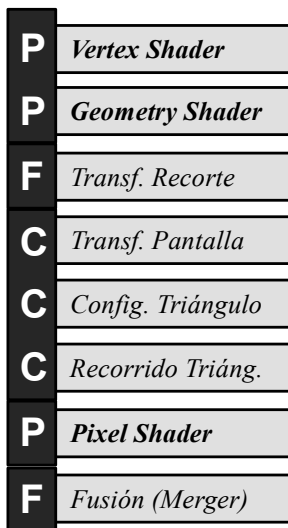
Figura 1.11: Implementación típica del pipeline en GPU. La letra asociada a cada etapa indica el nivel de modificación permitida al usuario; P indica totalmente programable, F indica fijo (no programable), y C indica configurable pero no programable.
