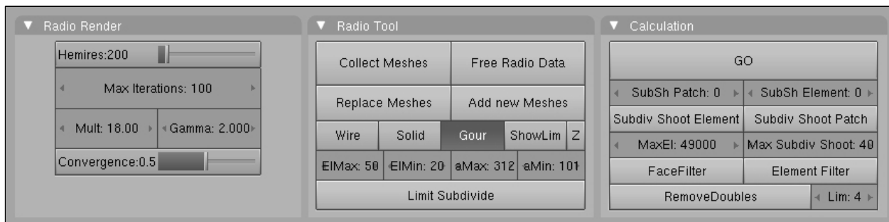
Figura 9.19: Opciones generales de Radiosidad (Paneles Radio Render , Radio Tool y Calculation ).
