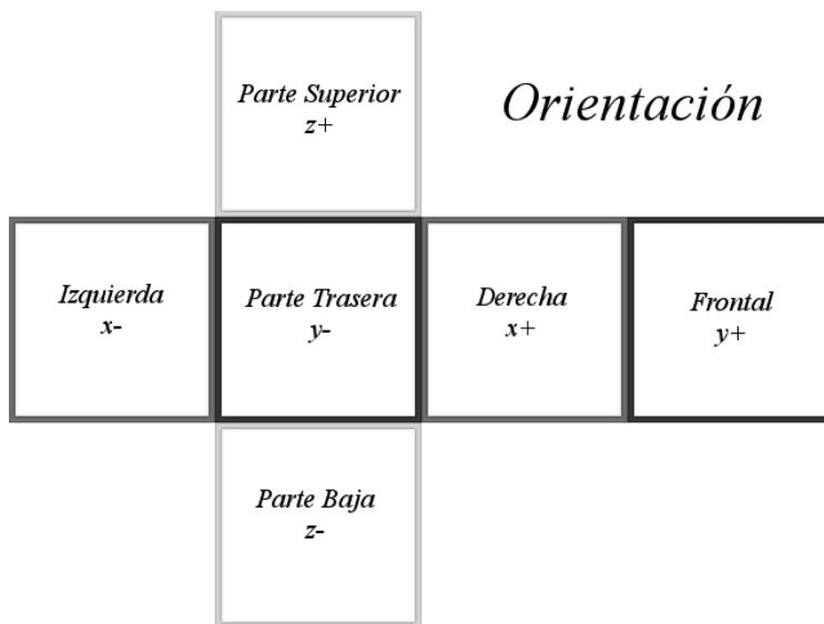
Figura 4.10: Orientación de las texturas aplicadas a un cubo
