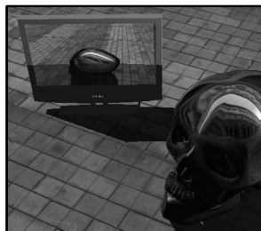
Figura 7.29: Tras aplicar el texture listener que oculta la entidad de la televisión, se consigue eliminar el efecto de despliegue recursivo.
